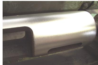
**Рис. 7. Плунжер, плакированный БрОЦС5-5-5**
