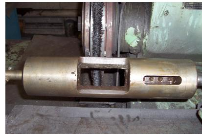
**Рис. 6. Плунжер пресса до обработки**
