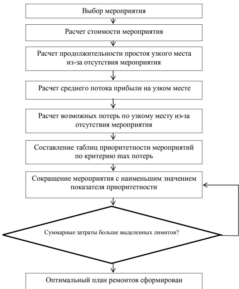
Рис. 3. Укрупненный алгоритм оптимального планирования мероприятий по ТОиР
