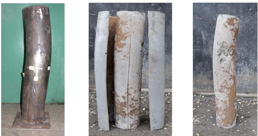
Рис. 5. Образцы серии ЦН.108.20 после испытаний
